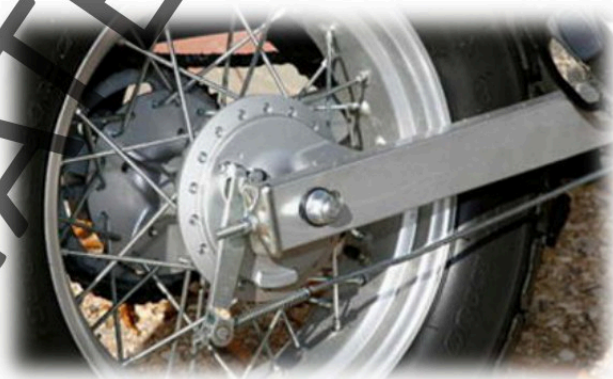
SISTEMA DE FRENADO POR TAMBOR Y ZAPATAS ACCIONAMIENTO MECÁNICO
