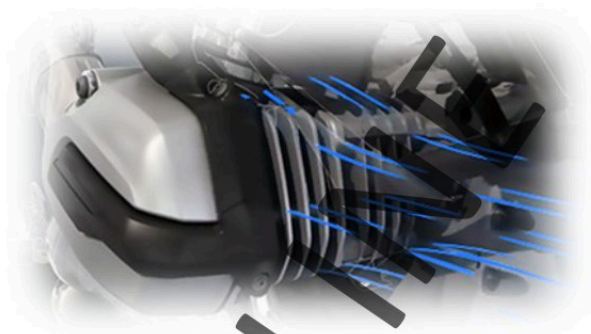
REFRIGERACIÓN POR AIRE
