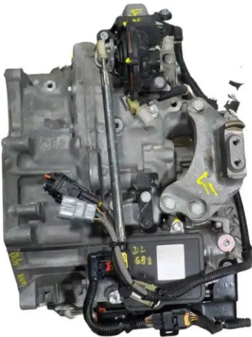
CAJA DE CAMBIOS MANUAL ROBOTIZADA
