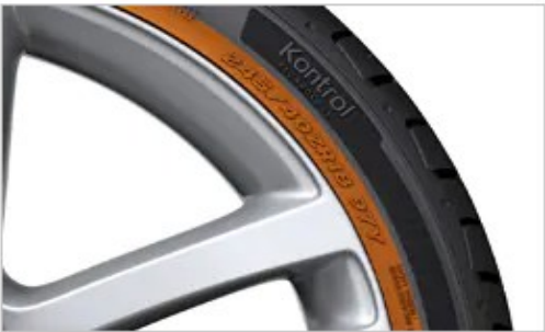
MEDIDA DEL NEUMÁTICO 245/40ZR18 97Y
