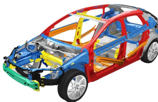
MATERIALES Y DEFORMACIÓN PROGRAMADA
