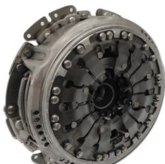
DOBLE EMBRAGUE DE FRICCIÓN EN SECO
