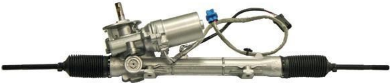
CAJA DE DIRECCIÓN POR CREMALLERA CON AYUDA ELÉCTRICA
