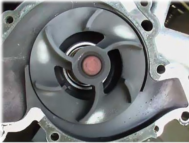
Bomba de agua en perfectas condiciones
