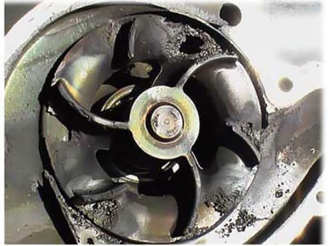
Bomba de agua deteriorada por la cavitación
