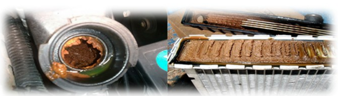
RADIADOR EN MAL ESTADO
